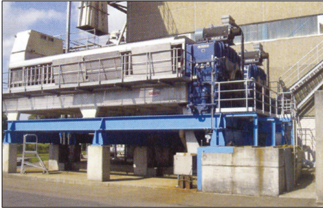
شکل ۷: فیلترپرس بابینی (PB48) در رگنس بورک
