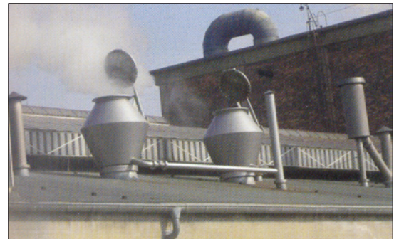
شکل ۶: دریچه باز کابین (اتاقک) گازهای هردو کربناتاسیون در شروع کار در کارخانه اکسن‌فورت
